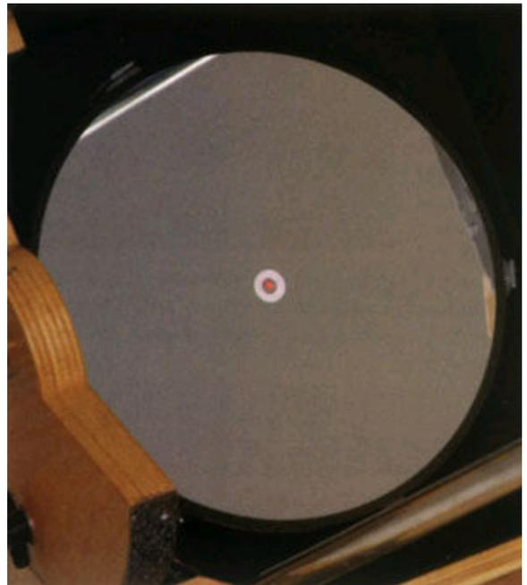
*A beállítás 2. lépése a segédtükör dőlésének állítása addig, amíg a lézersugár a főtükör középpontjába nem vetül. Ez biztosítja, hogy a fókuszírozó tükrözött tengelye a főtükör középpontjába mutat.*
