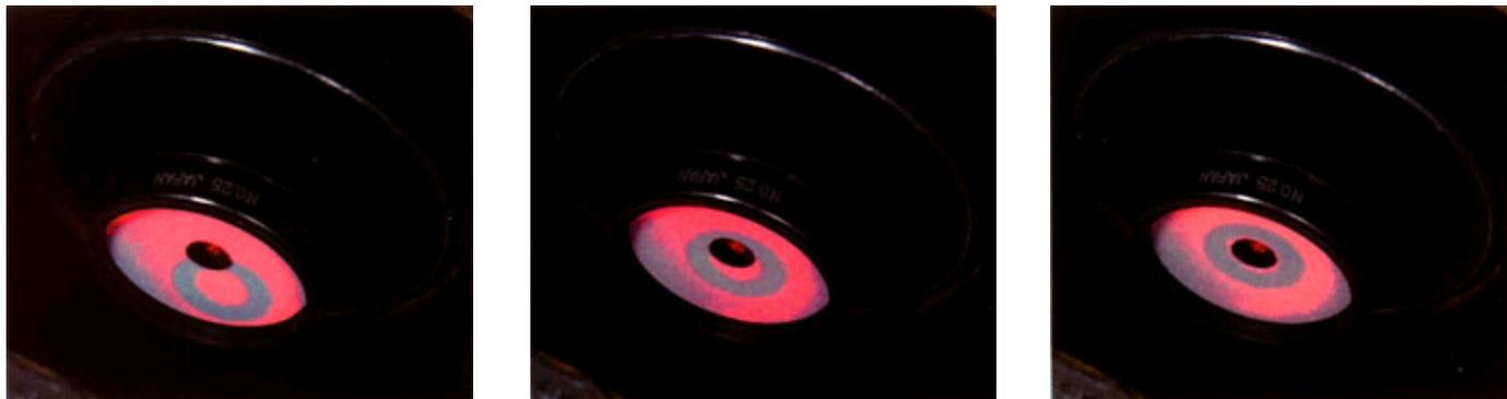
*Ez a fénykép-sorozat a Barlow-lencsés lézerkollimátorral történő végső beállítást mutatja, ami egyszerűen a főtükör központi korong-árnyékának a Barlow-lencsés lézer kilépőlyukjához történő központosítását jelenti a főtükör dőlésszögének állítgatásával.*
